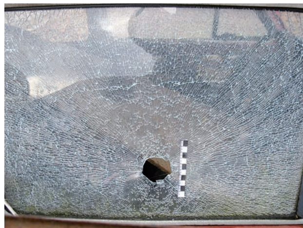
Ryc. 44. Uszkodzenie postrzałowe szyby bocznej samochodu. Strzał z odległości 4 m.
