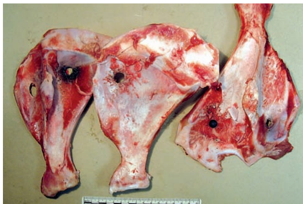
Ryc. 34. Efekt strzału z rewolwera ZORAKI przy użyciu kulistego pocisku kompozytowego oraz amunicji wzmocnionej naważką prochu bezdymnego.
