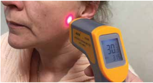
Ryc. 1: Badanie temperatury promieniem laserowym, wykonane pirometrem CA380 (CASON).
