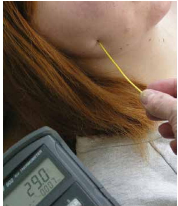
Ryc. 2: Badanie temperatury termometrem dotykowym (CHY 502).
