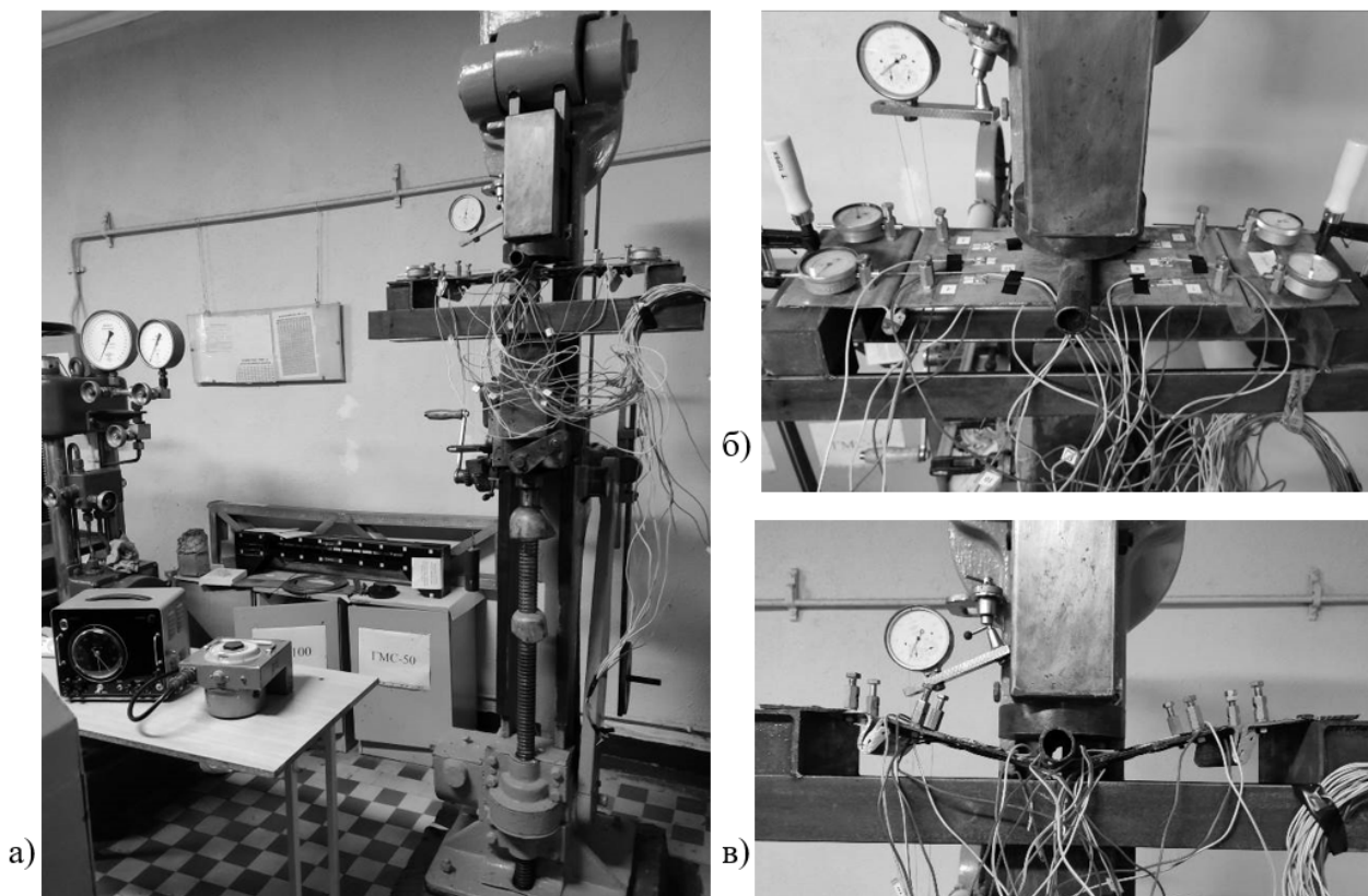
Рис. 3. Експериментальний зразок у випробувальній машині: а – загальний вигляд; б – вигляд до навантаження; в – вигляд після навантаження.
