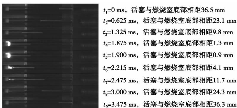
图 4 气体压缩着火试验图像(压缩比为 40.7)
