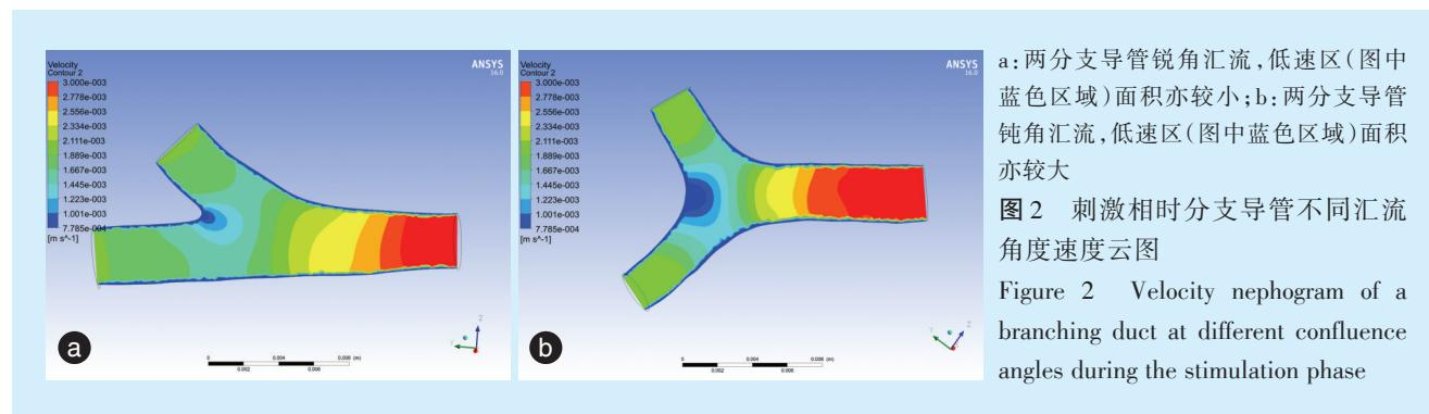
a:两分支导管锐角汇流,低速区(图中蓝色区域)面积亦较小;b:两分支导管钝角汇流,低速区(图中蓝色区域)面积亦较大
