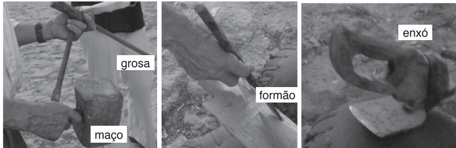
Figura 6 — Algumas das ferramentas para trabalhar a madeira e talhar o jugo
